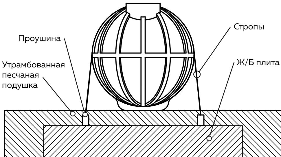
Емкости обязательно должны устанавливаться на подготовленные плиты-основания и крепиться к ним.
